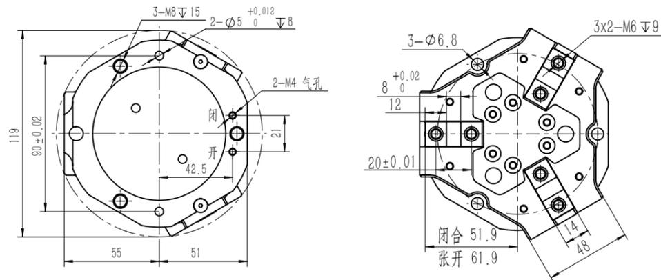
注：B底部通气款建议连接板沉孔 $\phi 8 \nabla 1$ ，密封圈 $\phi 5 \times 1.5$ 。
