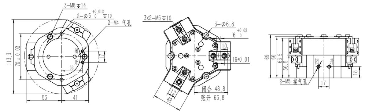
注：B底部通气款建议连接板沉孔 $\phi 8.5 \nabla 1$ ，密封圈 $\phi 5.5 \times 1.5$ 。
