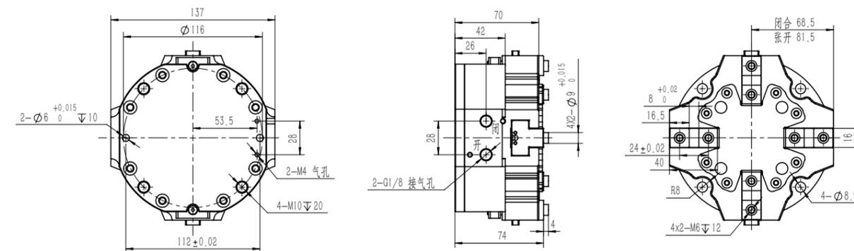
注：B底部通气款建议连接板沉孔φ8 ∇1，密封圈φ5\*1.5。
