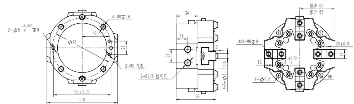
注：B底部通气款建议连接板沉孔 $\phi$ 8 $\nabla$ 1，密封圈 $\phi$ 5\*1.5。
